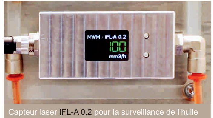
Capteur laser IFL-A 0.2 pour la surveillance de l'huile
