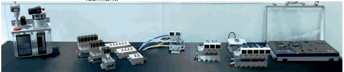
**Systèmes air-huile** sous forme d'unités complètes, prêtes à être installées. Le système air/huile est équipé d'une unité de contrôle, le mélange air/huile pour chaque point de lubrification est contrôlé par un capteur optique, en utilisant un mélangeur air/huile de type MVE-A et un capteur de stries d'huile IFX-C.
